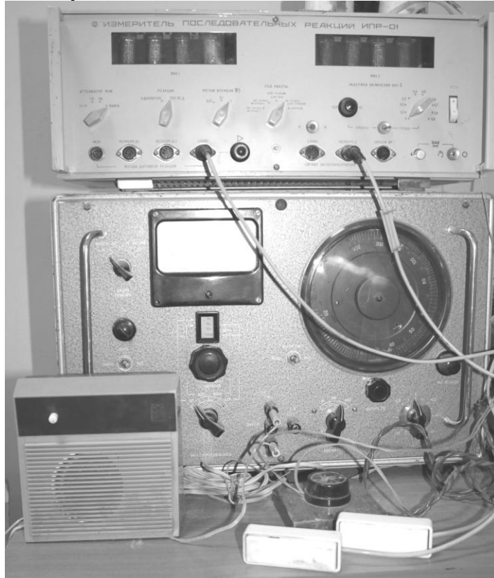
Рис. 9. Обладнання для визначення диференціальної чутливості слухового аналізатора
