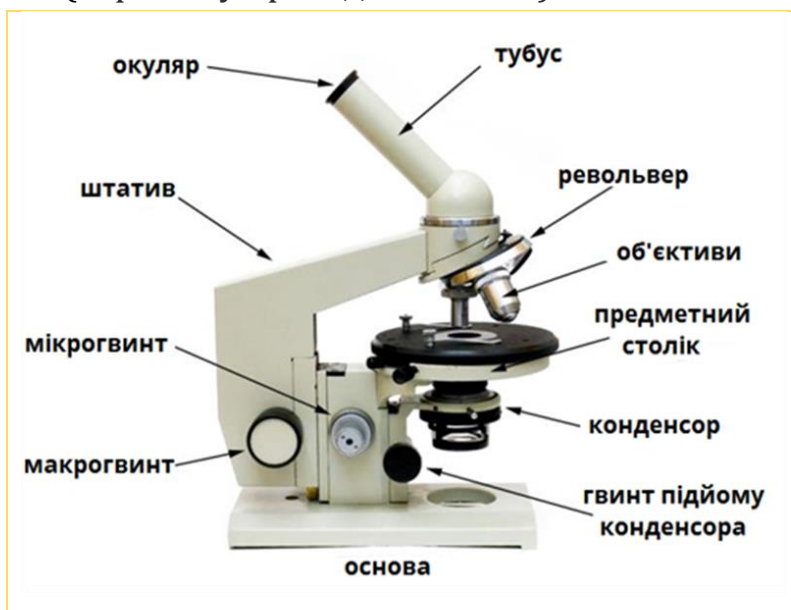
Рис. 13. Будова світлового мікроскопа
