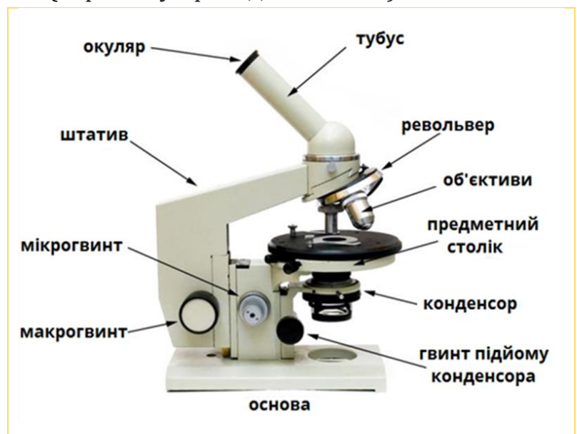
Рис. 13. Будова світлового мікроскопа
